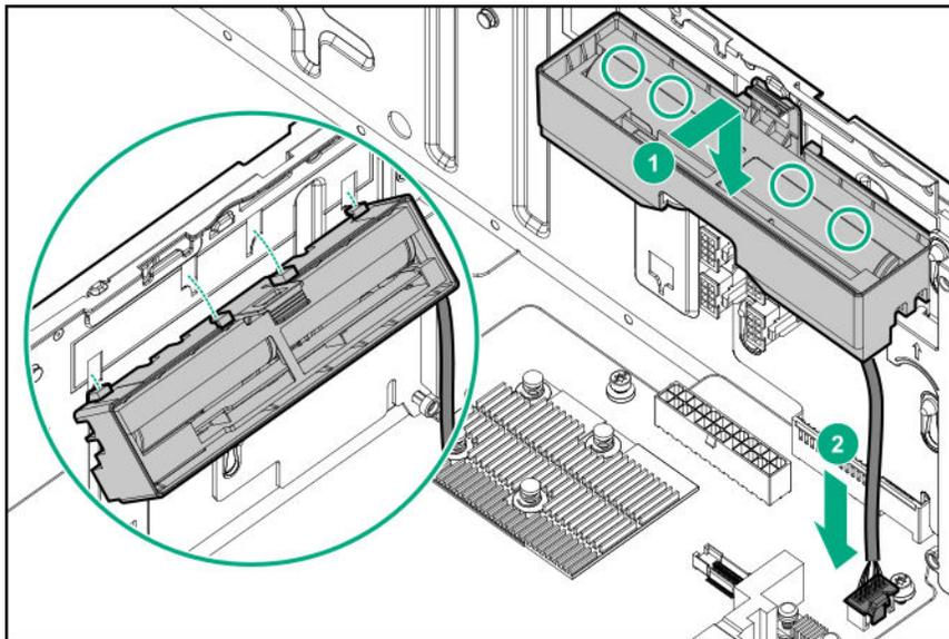
**5.** Install the air baffle.
